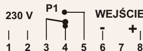
Podłączenie do czujnika wilgotności w systemie 4-20mA bez wykorzystania zewnętrznego zasilania linii prądowej
